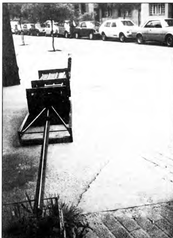
Foto 2: Con la Enfardadora Simplex es posible obtener fardos de hasta 20 kgs. de peso y de dimensiones normales (42 x 43 x 100 cm.).
